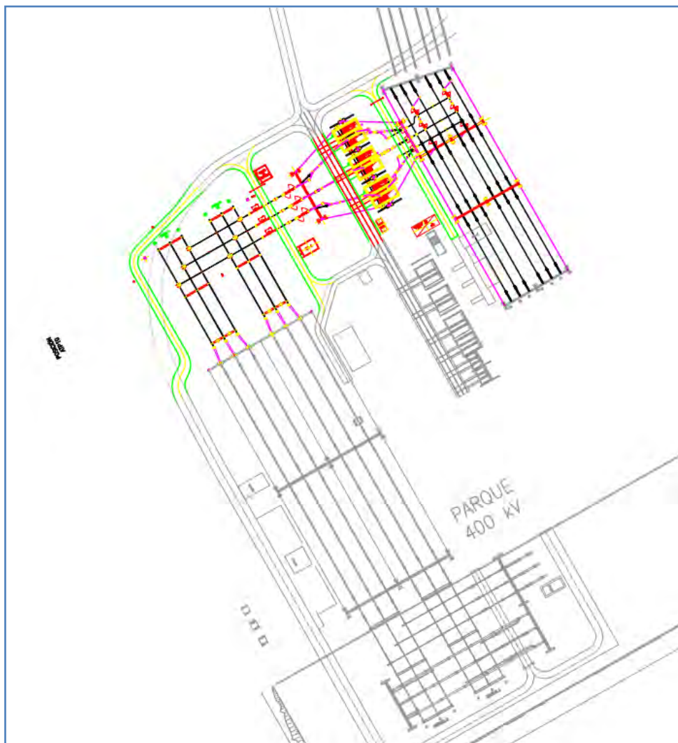
Figura 21. Proyecto de ampliación de la subestación eléctrica de Escatrón.
